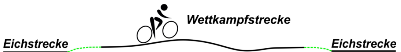
Abb.3: Die „kalibrierte Fahrrad-Messmethode“
